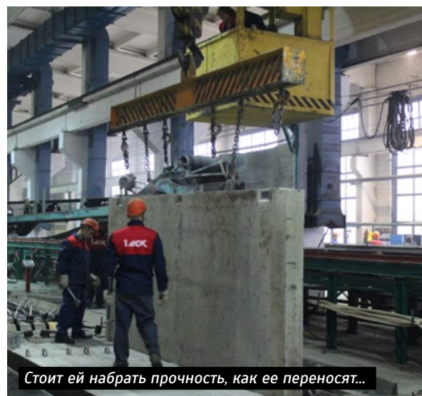
Арматуру заливают раствором и получается панель. Пока сырая
