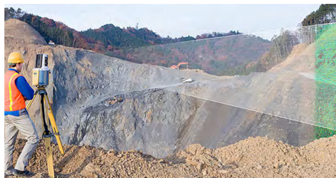
Рис. 2. Принцип наземного лазерного сканирования.
