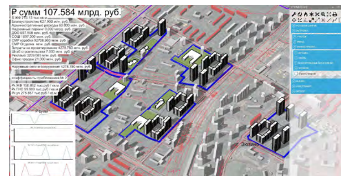
Рис. 3. Генерация вариантов застройки участка и подсчет ТЭП с помощью Робота R1, разработанного в ООО «ПИК-Проект».
