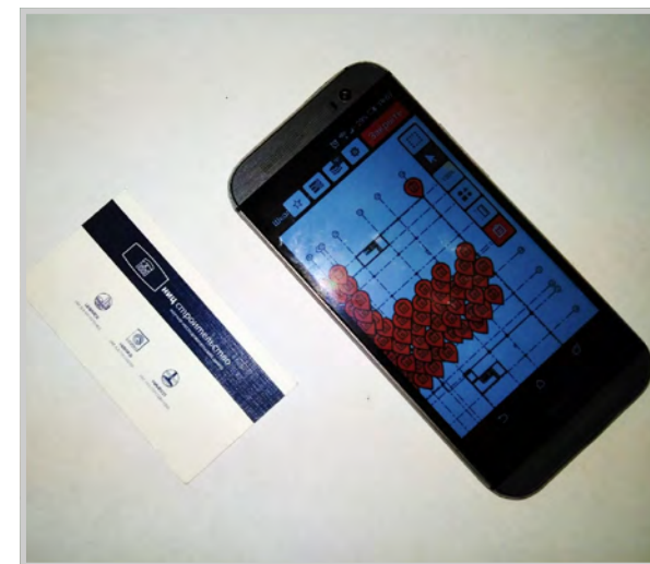
Пример фиксации дефектов и отклонений в мобильном приложении Стройконтроль
