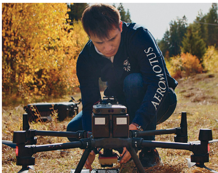
Установка специалистом Aeromotus подвеса на Matrice 300 RTK
