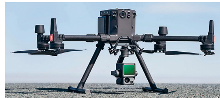
Беспилотный комплекс для воздушного лазерного сканирования DJI Matrice 300 RTK + Zenmuse L1
