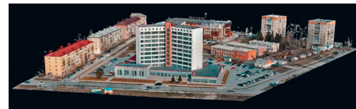
Фотограмметрическая съемка с помощью Matrice 300 RTK + Zenmuse P1
