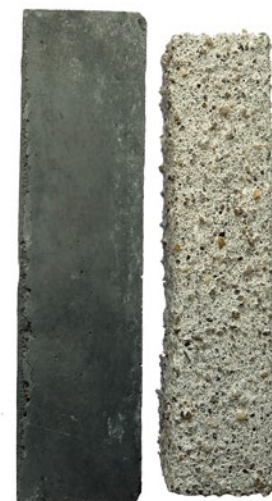
Геобетон и бетон после испытаний в серной кислоте
