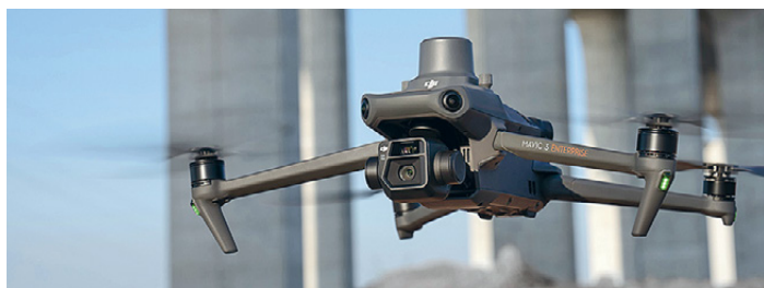
Портативный складной дрон Mavic 3 Enterprise для фотограмметрии с модулем RTK
